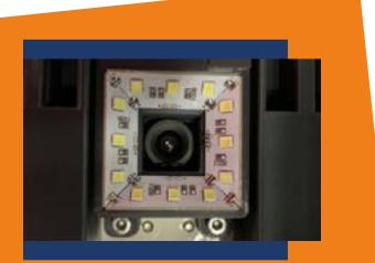
FULL VISION SYSTEM FOR FIDUCIAL AND PCB POSITION RECOGNITION
