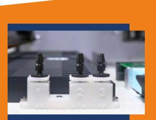
NOZZLE EXCHANGE STATION FOR MULTI NOZZLES USAGE
